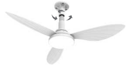
Instalación de casquillo E27 tipo rosca
